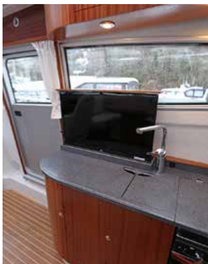
INTEGRERT: TV'en heises opp og ned i bakkant av byssebenken.
